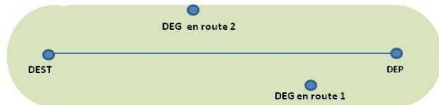
**Exemple de route étroite avec dégagement en route (cas d'un vol en VFR)**
